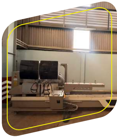
Máy cắt nhôm lưỡi 500 CNC (CNC Aluminum cutting machine with a 500mm blade)
